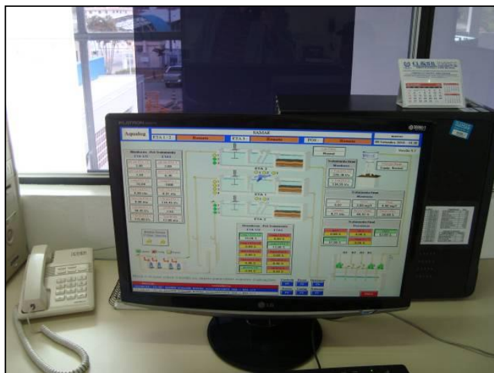
Figura 21: Tela do Sistema Supervisório Instalado na Sala de Operação.
